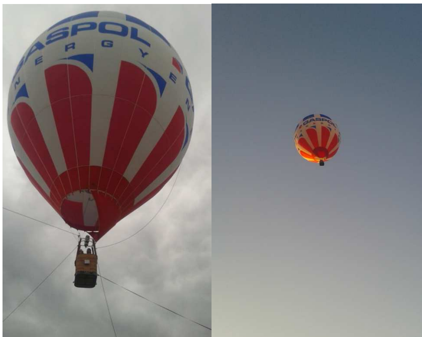
Fotografia 4. Pomiary z użyciem balonu na ogrzane powietrze; urządzenie pomiarowe umieszczono na koszu balonu. Fotografia własna.
