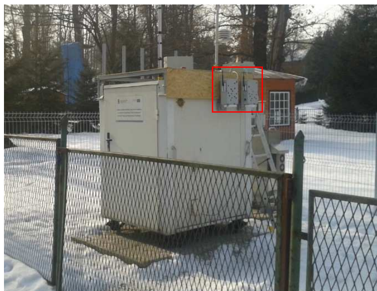
Fotografia 1. Urządzenia pomiarowe na stacji PMŚ w Rabce-Zdroju. Dwa testowane urządzenia pomiarowe z sensorami niskokosztowymi zostały zaznaczone za pomocą czerwonej ramki. Fotografia własna
