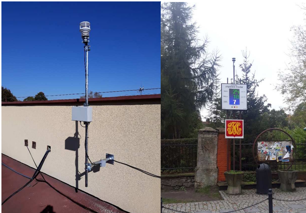
Fotografia 1. Po lewej – urządzenie do pomiaru stężeń pyłów (projekt i realizacja własna) wraz z głowicą meteorologiczną, po prawej – wyświetlacz prezentujący w trybie rzeczywistym dane z urządzenia pomiarowego. Fotografia własna.
